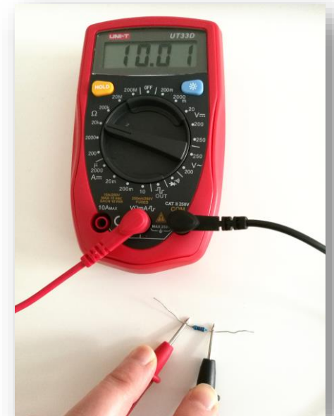
Resistanssin mittaaminen yleismittarilla
